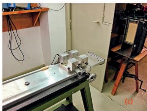
Ballistische Experimente an der PTB Braunschweig: a) Prof. Dr. Frank Jäger und Kollegen der PTB-Braunschweig inspizieren den Schussapparat; b) Lichtschranke für die Vermessung der Geschwindigkeit; c) Luftkanone mit Projektil und Zielvorrichtung im Schusskanal.
