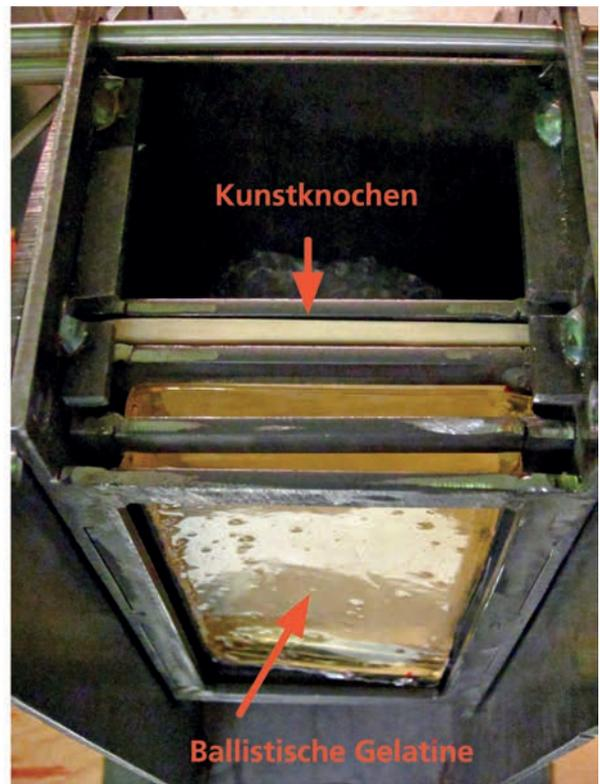
Links: typischer Aufprallschaden an der Spitze eines Geschosses. Rechts: Zielvorrichtung mit ballistischer Gelatine und Kunstknochen.
